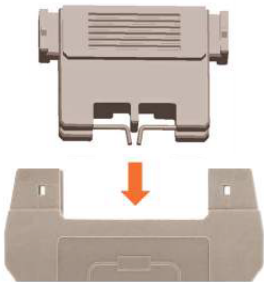
步骤三：再将组装好的二极管 ☒☒☒装回元件插头
