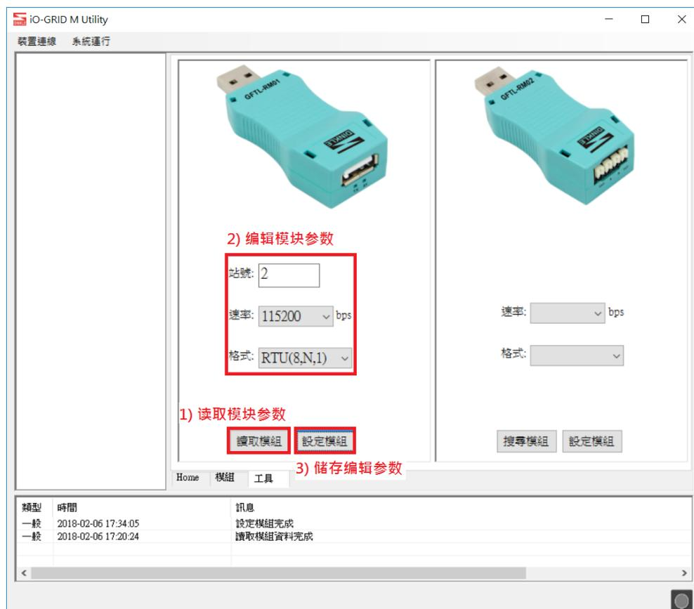
图18 单片 I/O 模块参数设定
