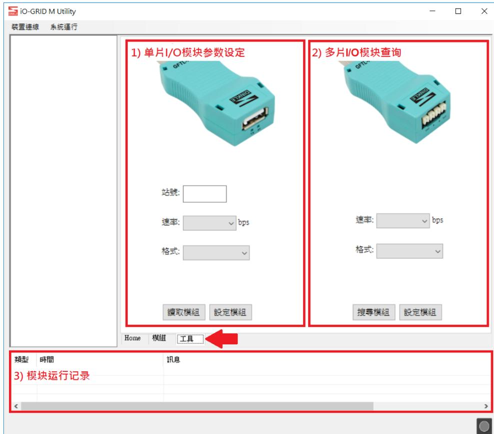
图16 iO-GRID M Utility 软件主画面
