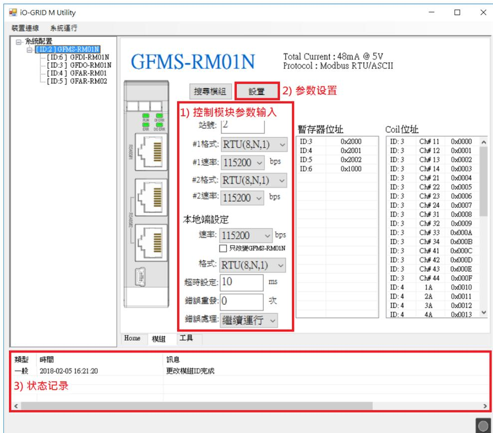
图16 控制模块参数设定
