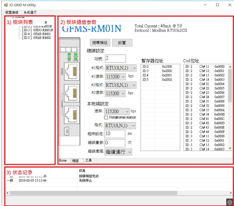
图13 iO-GRID M Utility 软件主画面
