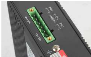
双电源输入设计 提供稳健的工业通讯方案
