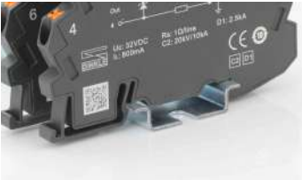
底部卡簧与导轨通过四点可靠连接，经金属导轨接地
