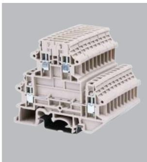
DKK2.5N-T..系列是双层独立电位的带闸刀开关接线端子。顶部带通用插座，方便插入各种隔离插头、直通连接器和组件连接器，实现断开功能，下层直通。
