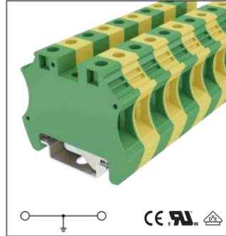
DK...PE 是一种保护接线端子，符合UL 1059 和 IEC 60947-7-2 标准，DIN 导轨不仅是 PCTB 的机械支撑，也具有 PCTB 的电气功能，用作接地 (PE) 母线。
