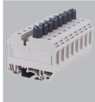
DK..-TF 系列是一种保险丝端子，适用 TS-35N / TS-35/15N 两种标准轨道。适用直径 5mm 的保险丝管，适合操作空间有限的应用。保险丝不包括在标准部件号中。
