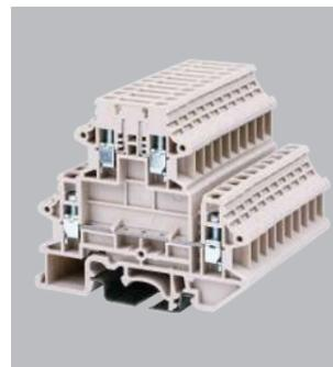
DKK4N-T..系列是每层独立电位的双层闸刀开关接线端子。顶部通用插座，方便插入各种隔离插头、直通连接器和组件连接器，实现断开功能。
