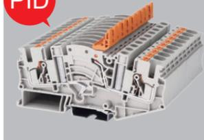
该开关测试端子，专为电流互感器二次回路设计，DPTD6N和DPTL6N利用固定外接片、开关手柄和4mm的测试插件组成一个简单的测试电路。
