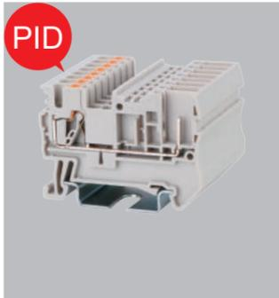
DPES2.5 是一种可插拔外接端子，实现信号传输和供电功能。抗振插入设计使插头牢固地连接到端子座上。电流可以任意选择从底座或插头输入。
