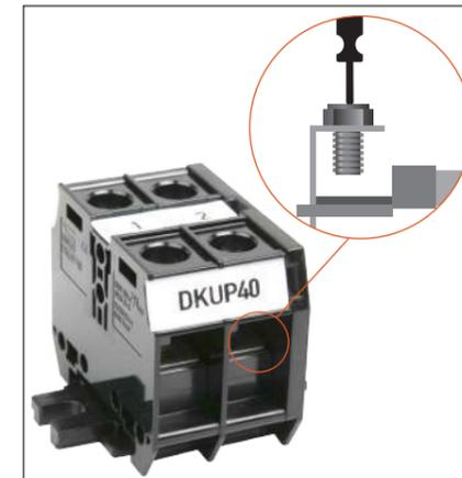
DKUP 系列是一种特殊的结构，螺母由顶盖上的弹簧引导，处于接线已准备好的状态，以节省拧松螺丝的时间，也可以防止螺丝丢失。
